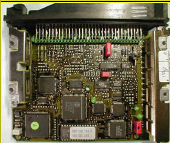
**CENTRALINA DI GESTIONE MOTORE MOTRONIC M3.7.1 INSTALLATA SULLE VETTURE DEL GRUPPO FIAT BENZINA.**
